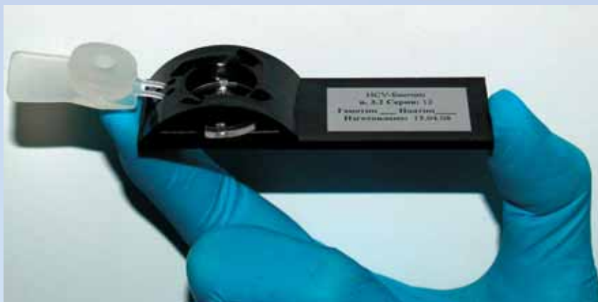
Гелевый биочип для определения генотипа и подтипа вируса гепатита С, созданный в ИМБ РАН (Москва). Фото из архива лаборатории биологических микрочипов ИМБ РАН. Подробнее на с. 50—59
